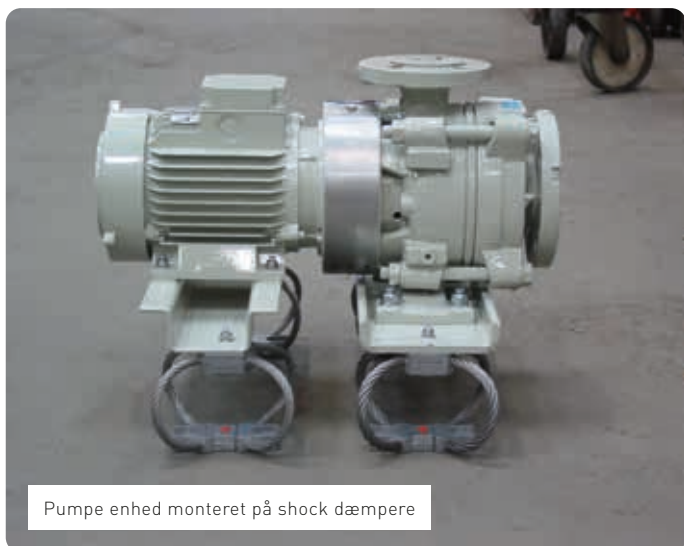
Chok-isolering af Sea Beacon på bølge, Farvandsvæsenet
